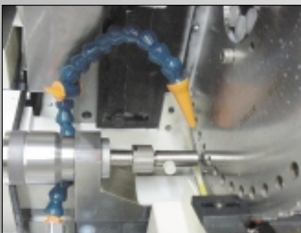
IONIC-Messtaster bei Messwertaufnahme Measuring probe for measuring taking Palpeur de mesure IONIC pour contrôle de mesures pièces
